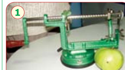
1 Конструкция крепится к столу с помощью присоски.
